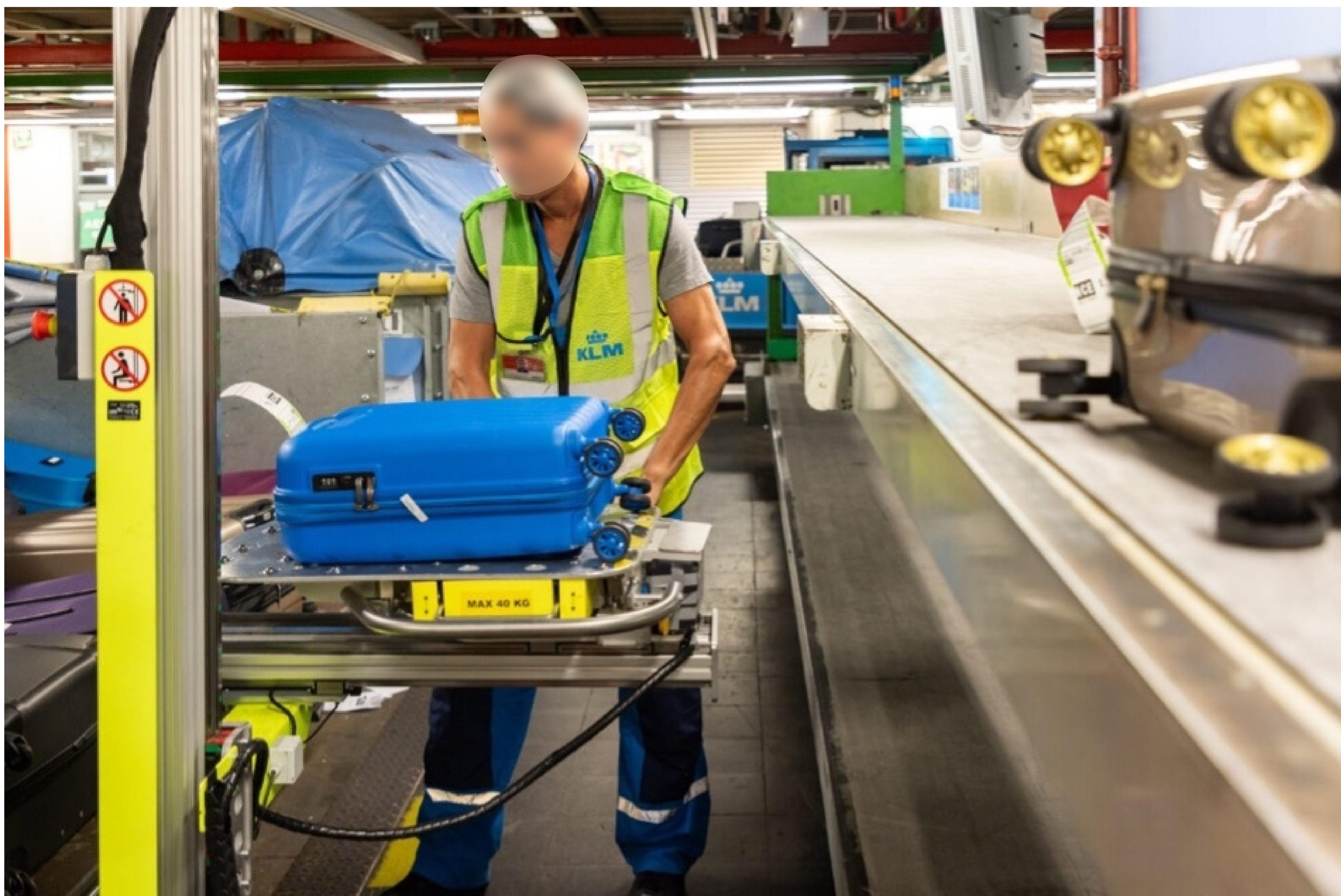
Het laden van bagage van een lateral in een bagagekar (met gebruik van e-CLS)
