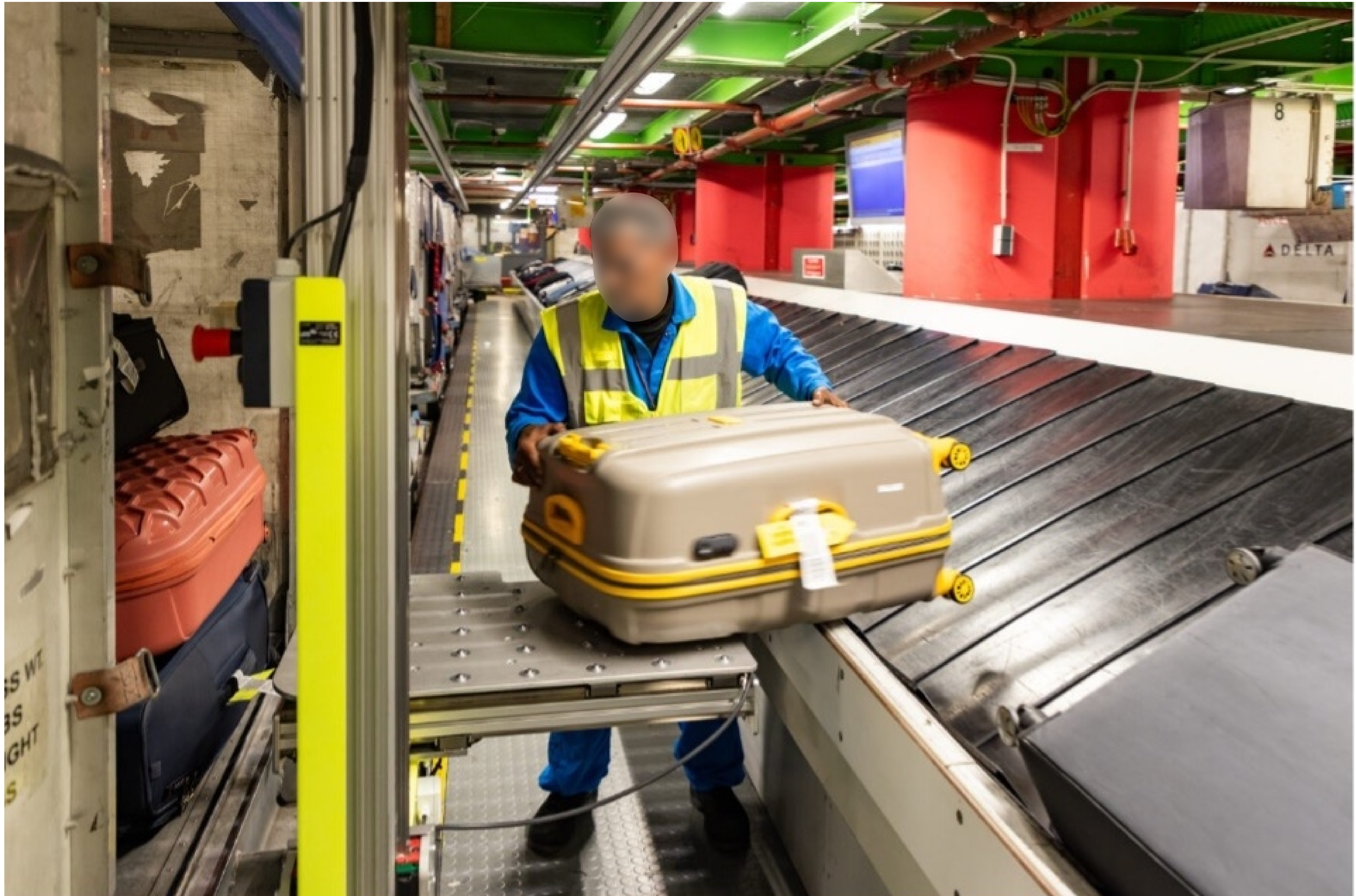
Het laden van bagage van een carousel in een container (met gebruik van e-CLS)
