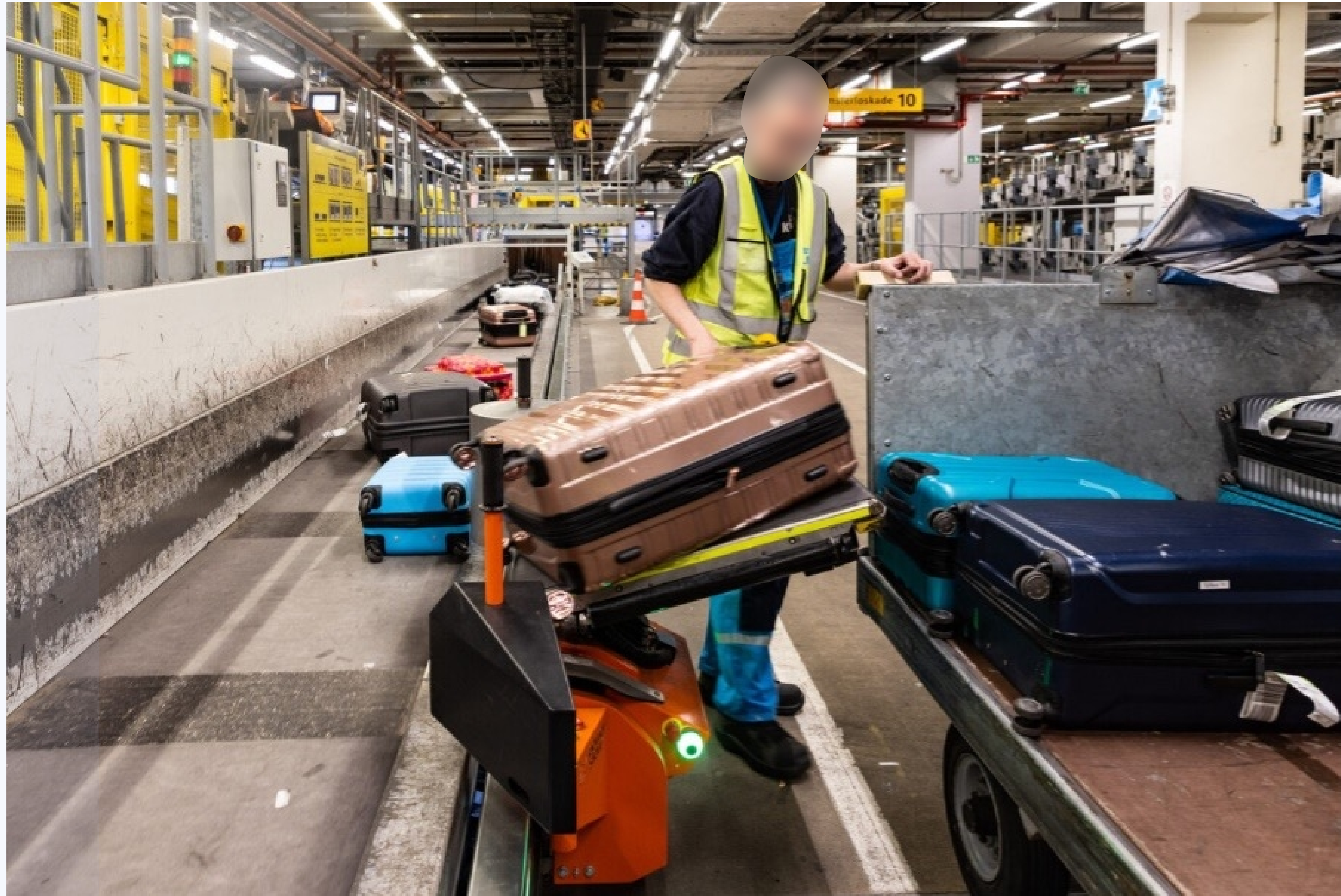
Het lossen van transferbagage uit een kar, met gebruik van een Transferbelt
